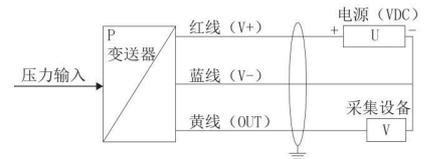
☞ 代表屏蔽线,所标注接地点须全部有效接地。建议选用带屏蔽双绞信号电缆效果最佳。为了避免接地回路,屏蔽层采用单端接地,在压力变送器端绝缘浮地,并在控制柜端接地。
