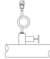
高温蒸汽测量, 建议加装活接缓冲管 (ZB02), 应预先在冷却管中注入多半管冷却水 (气液隔温)。以保证测压点温度在可控范围内。(需单独购买附件)
