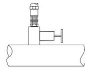
高温介质测量, 应在测量管道与测量点之间加装转接散热装置, 如散热片转接件 ZB03, 以保证测压点温度在可控范围内。(需单独购买附件)
